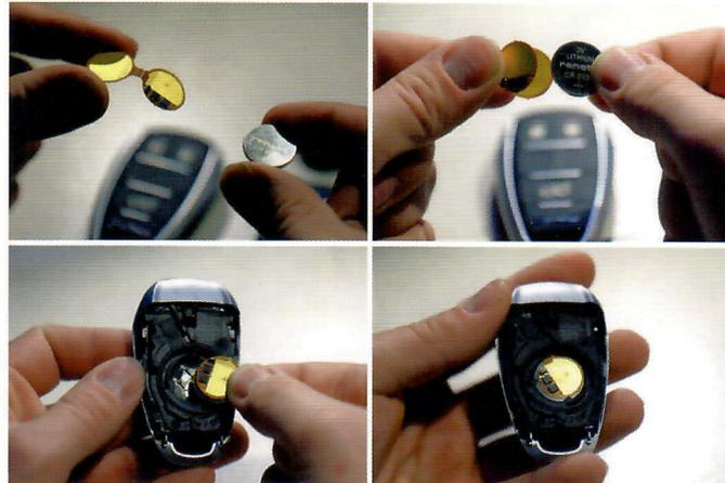
Keyless Protector, deaktiviert und aktiviert den Schlüssel mit Hilfe eines **Bewegungssensors**, dessen Daten von einem Mikroprozessor ausgewertet werden. Eine intelligente Programmierung steuert die Stromversorgung des Schlüssels. Ein Dieb kann den Schlüssel nicht ohne Strom scannen!
