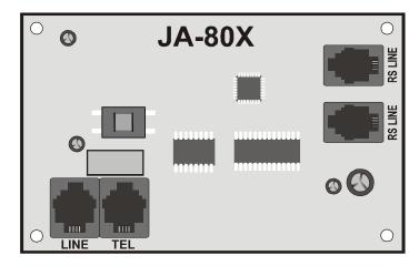
**Hinweis:** Das Kommunikationsmodul muss direkt an eine Telefonbuchse angeschlossen werden. Alle anderen Geräte sollten an den Ausgang TEL des Kommunikationsmoduls angeschlossen werden.
