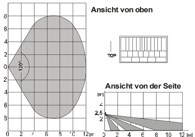
Die Charakteristik kann durch den Einsatz einer alternativen Linse geändert werden:
